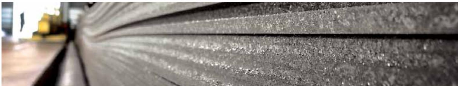
板材的规格通常为长 6 米、10 米或 12.2 米，宽 2 米、2.5 米和 3.05 米。同时，通过管磨机厂，我们可供应各种长度和宽度的板材，并且有多种材料规格可供选择。
